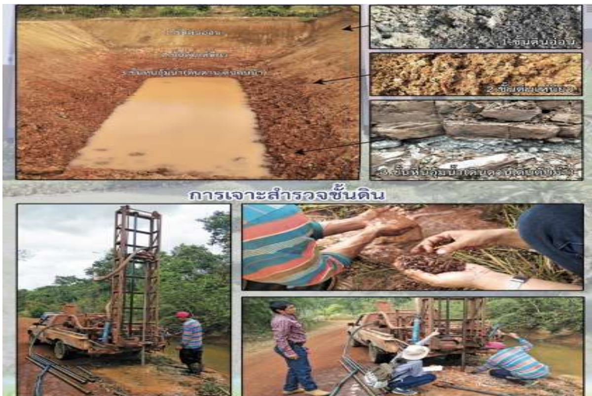
รูปที่ 5-11 ตัวอย่างการเจาะสำรวจชั้นดิน
