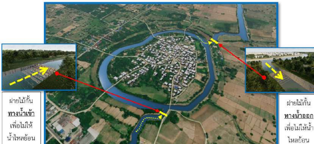
ภาพที่ 6 แสดงการผันน้ำเข้าคูน้ำรอบชุมชนเพื่อให้ไหลเวียนไปไล่น้ำเก่าออกไปบริเวณที่ต่ำท้ายเมือง
